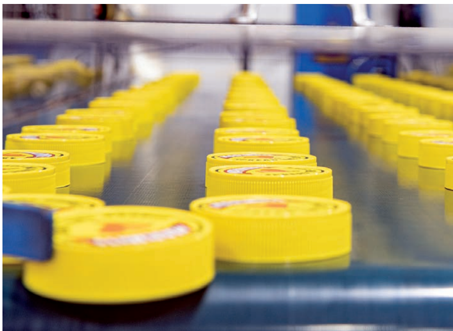
Non-stop doppen fabriceren, al dan niet voorzien van een plastic afsluitlaagje. Na een razendsnelle cameracontrole worden ze automatisch in klaarstaande dozen verzameld.
